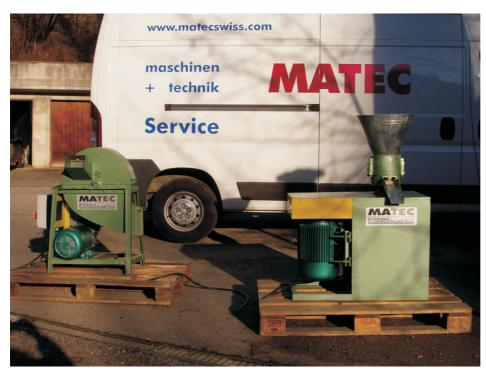
Die Hammermühle links im Bild kombiniert mit der Pelletiermaschine rechts bilden ein effizientes Duo zur Herstellung von hochwertigen Pellets aus trockenen Spänen aus Schreinereien, Zimmereien, Sägewerken. Für eine gute Pelletqualität ist die passende Mischung aus Sägemehl- Schleifstaub bei einer Holzfeuchte von 10-14% entscheidend mit Materialkonditionierung.
