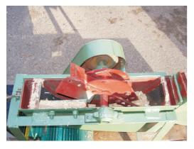
Hammermühle geöffnet mit fliegenden Hämmern und Schaufeln, Sieb 6mm
