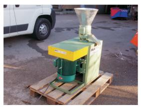
Pelletiermaschine für manuelle Beschickung. Drehende Matrize mit 2 stationären Kollern. Komplette elektrische Ausrüstung mit Hauptschalter, Motorschutzschalter mit Thermoschutz. Materialzuführung und Abtransport mit Schnecken, Kratzkettenförderern oder Vibrorinne optional lieferbar.
