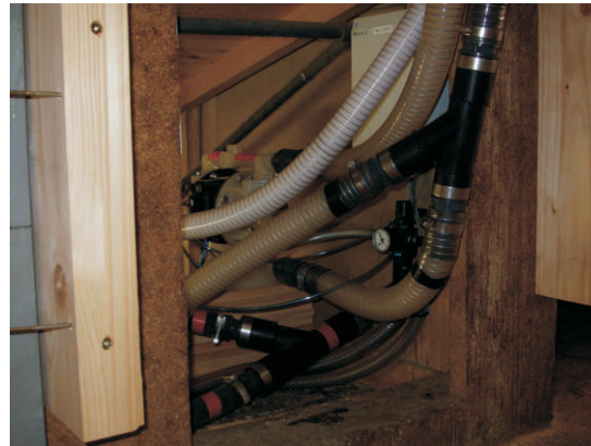
Weiss: Härterzuführung, Beige: Leim mit Y-Verzweigung, dahinter Membranpumpe mit Hubzähler, für die Mengenregistrierung
