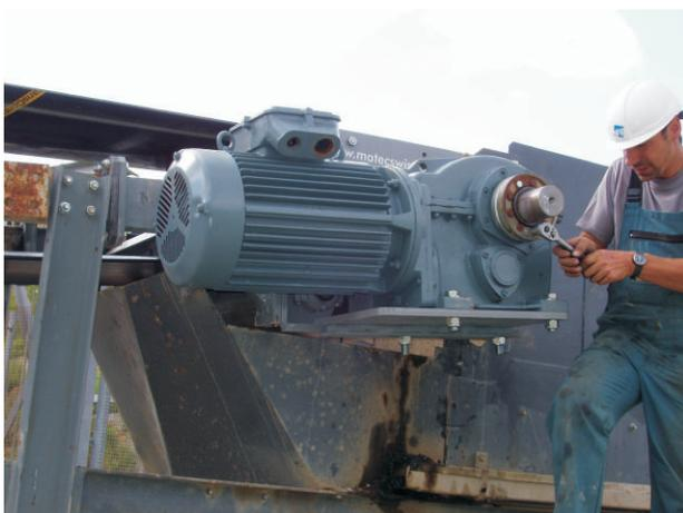
Getriebemotor anheben, auf Welle schieben, Platte als Drehmomentstütze unten festschrauben, doppelkonischen Spannsatz über Nabe schieben, festschrauben, Sicherungsbuchse mit Druckscheibe am Wellenende festschrauben, fertig !
