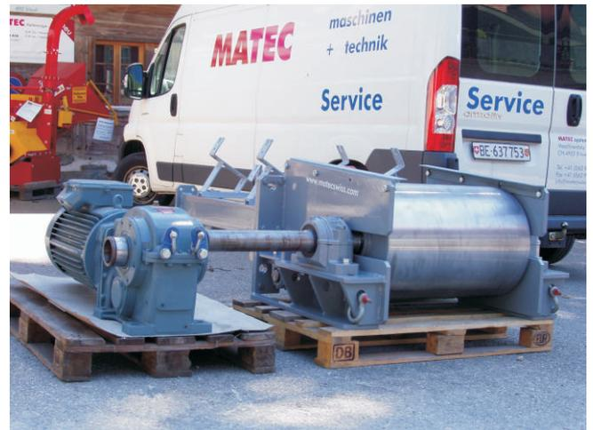
MATEC-Förderband-Kopfstation mit Trommeldurchmesser 500 mm, ohne Traktionsbelag, Gurtbreite 650 mm
