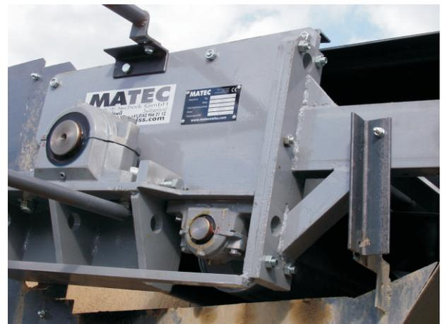
Von unten einschiebbare Anpressrolle, Schraubflansch zum raschen Befestigen der Kopfstation
