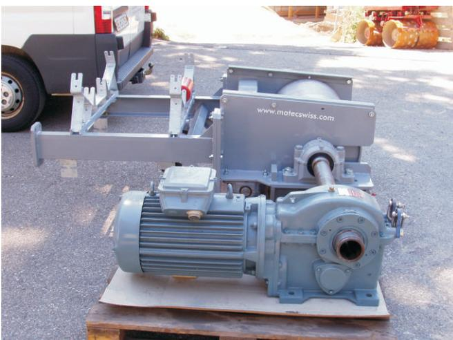
Das MATEC-2-Flanschsystem erleichtert die Baumontage einer neuen Kopfstation wesentlich, da nur der leichte Zwischenflansch an das bestehende Bandchassis angepasst werden muss, ohne die ganze Kopfstation!!! Der einfache Zwischenflansch kann vor Ort mit einfachen Mitteln angepasst werden und die extrem kurz gebaute Kopfstation mit Anpressrolle kann komplett vormontiert im Gurt «eingefädelt» und anschliessend an den beiden 6-Schrauben-Flanschplatten einfach festgeschraubt werden.
