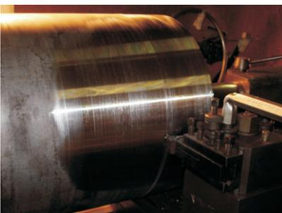
Ueberdrehen der Antriebsrolle Durchmesser 500 mm auf der Drehbank
