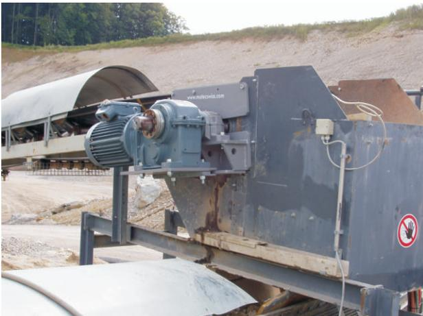
MATEC FBK 1S500 Förderband-Kopfstation eingebaut mit Uebergabebehälter, Getriebemotor 22 kW, Drehmoment ca. 3500 Nm
