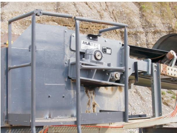
Auf der Baustelle angepasster Zwischenflansch rechts des vertikalen Geländerpfostens
