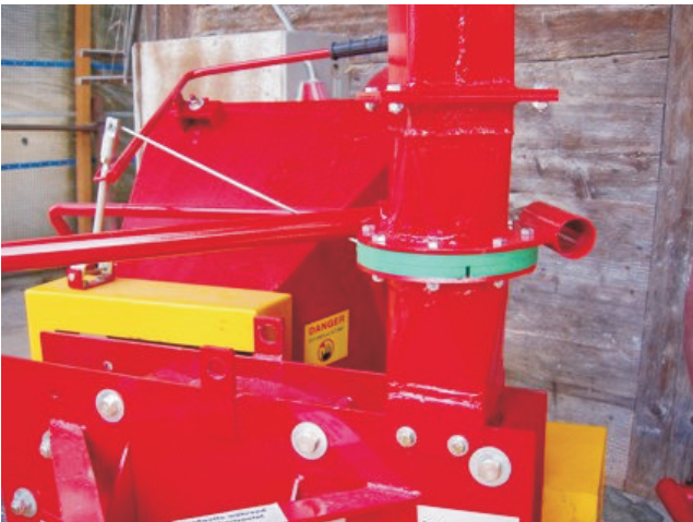
Option gegen Aufpreis: Drehvorrichtung kunststoffgelagert mit Hebel zum Einstecken in 2 Positionen
