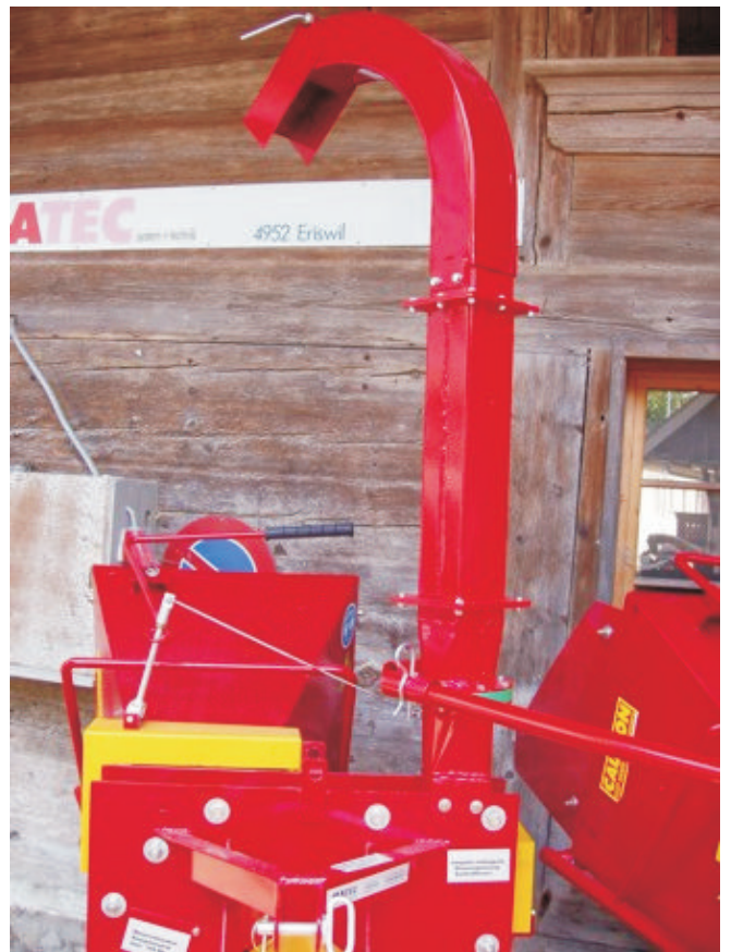
Option gegen Aufpreis: erhöhter und drehbarer Auswurf (Standardhöhe 1600 mm, Drehvorrichtung +300 mm, Rohrverlängerung +300 mm) mit Flanschverbindung zum Schrauben
