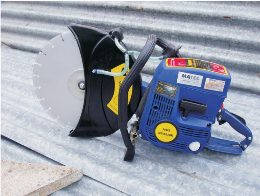
**MATEC Steinsägen** sind vielseitig einsetzbare, robuste Geräte für den Einsatz im Hoch- und Tiefbau, Gartenbau, Landwirtschaft, Umbau, Unterhaltsbetrieben von Gemeinden usw. Das Diamantblatt mit Wasserkühlung schneidet Naturstein, Beton, Backstein, Kalksandstein, Asphalt, Unterlagsböden usw. Die Geräte laufen leicht an und bieten ein ausgewogenes Leistungsverhalten im Sommer- und Winterbetrieb.
