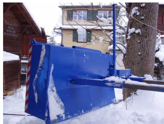
Kippen über Hebel mit Seilzug Rückstellung durch Rückwärtsfahrt und Herunterlassen der Schaufel, Federschnapp-Sicherung
