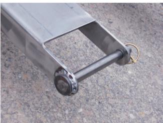
Sicherungsbolzen mit Klappsplint
