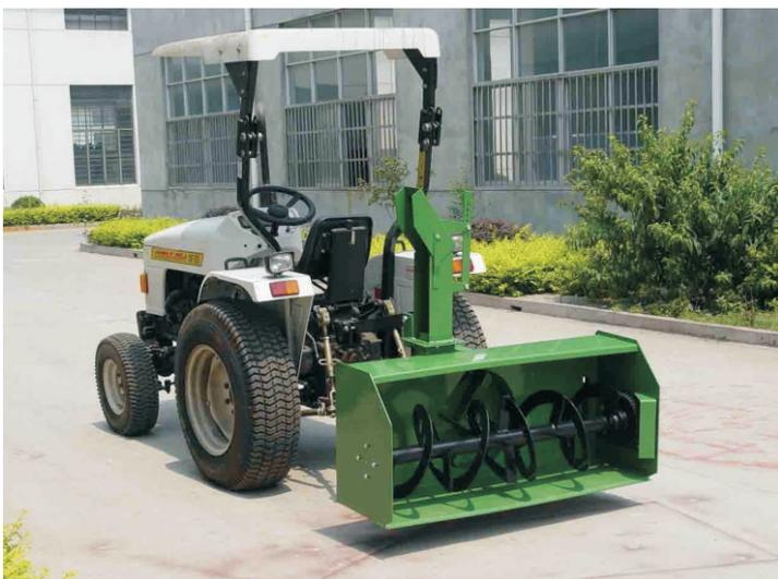
Schneefräse für Dreipunktanbau oder Frontladeranbau. Arbeitsbreite 1350 oder 1650 mm, Arbeitshöhe 600 mm. Drehbarer Auswurf mit Visier einstellbar.
