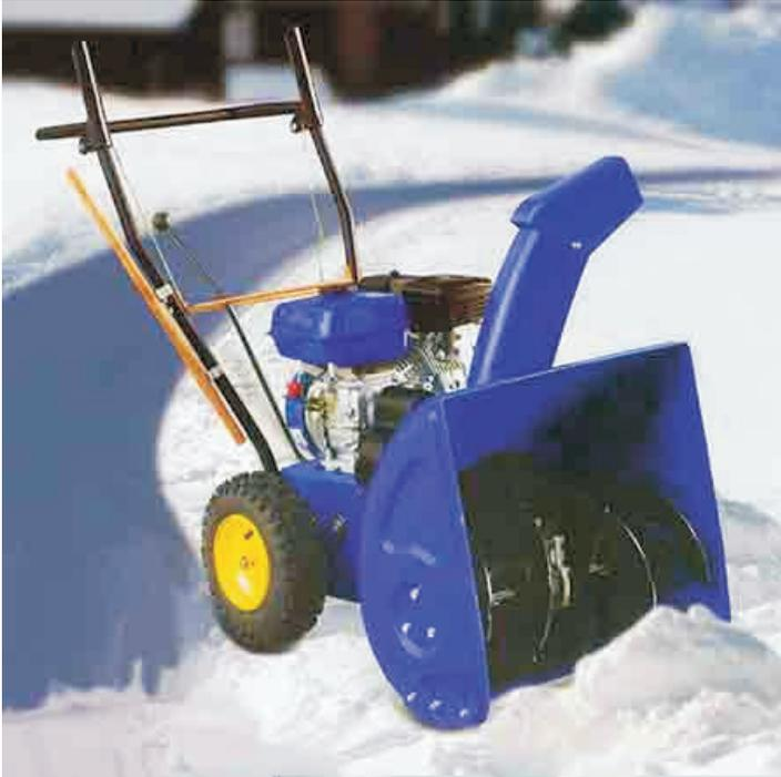
Manuelle Schneefräse mit Benzinmotor 5,5 PS, resp. 6,5 PS Räumbreite max. 560 mm, Räumhöhe max. 510 mm mit Sicherheitsbedienung, Seilzugstarter resp. Elektrostart. Das Auswurfrohr ist 190° drehbar und das Auswurfvisier ist ebenfalls einstellbar. 5 Vorwärtsgänge, 2 Rückwärtsgänge CE-konform, TÜV geprüft Schneeketten
