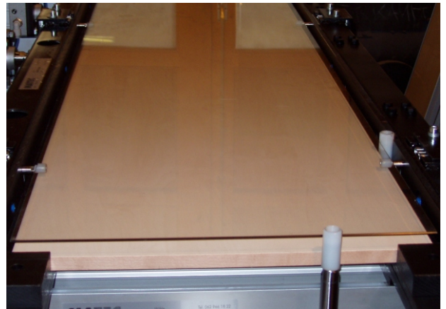
Anschlag- und Auflagezylinder für die exakte Positionierung der Werkstücke
