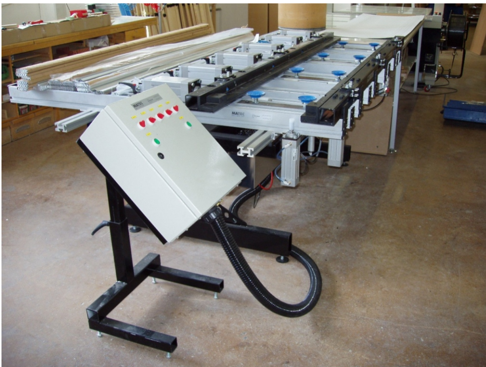
MATEC Montagetisch MATABLE MATMT Spezial für Schranktüren mit Pneumatikbedienpult
