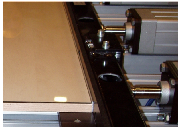
Robuste und leistungsstarke Zylinder für den Pressvorgang
