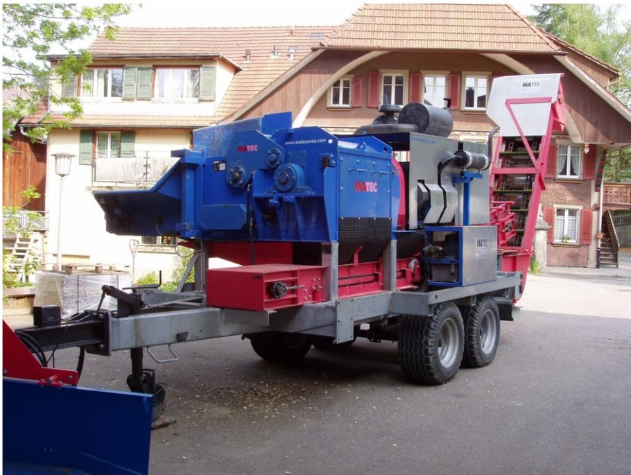
Hochleistungs-Trommelhacker für Leistungen bis über 150 m<sup>3</sup> Schnitzel/Stunde bei optimaler Beschickung und Einzugsge-
