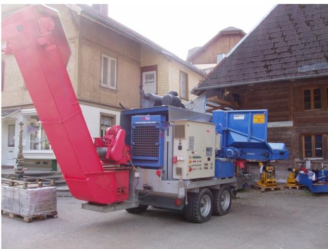
Dieses Schweizer Produkt stammt aus hauseigener Fertigung. Der Hauptantrieb mit 200 PS Dieselmotor treibt den 2-Messerrotor an. Die Nebenantriebe laufen elektrisch und werden von einem 34 PS Diesel über ein 20 KVA-Aggregat mit Strom versorgt.
