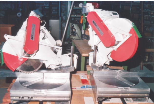
Der robuste Drehteller der Säge ist mit einem Drucklager ausgerüstet und am Umfang zusätzlich abgestützt. Die üblichen Gehrungswinkel können per Raster schnell eingestellt werden und der Drehteller kann in jeder Position zusätzlich geklemmt werden. Der Gehrungsbereich umfasst 45° nach links und rechts. Die Schrägstellung in vertikaler Ebene umfasst 45° entweder nach links oder rechts.
