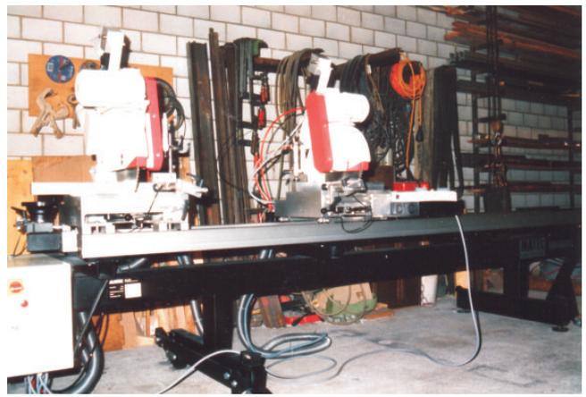
Die äusserst kompakte Maschinenbauweise in Links- und Rechtsausführung basiert auf einem konsequent modularen Konzept. Der Antriebsmotor, die Riemenübersetzung, die Verstellung in horizontaler Ebene, wie auch diejenige in vertikaler Ebene, kann dem Bedarf und dem Material angepasst werden. Der Arbeitszyklus ist über eine SPS-Steuerung geregelt und kann nach Bedarf umgestellt werden. Das Bedienpult mit 2-Hand-Auslösung kann am optimalen Bediener-Standort angebracht werden.
