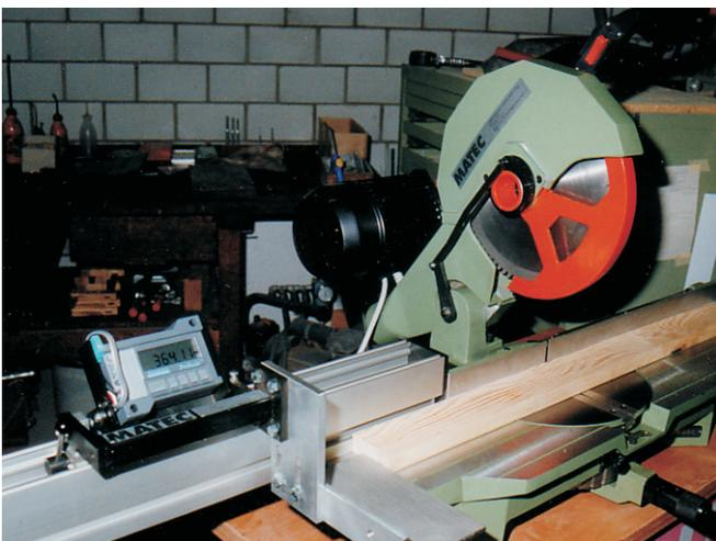
MATMODUL light PS mit integriertem digitalem Längenmesssystem montiert auf Kappsäge
