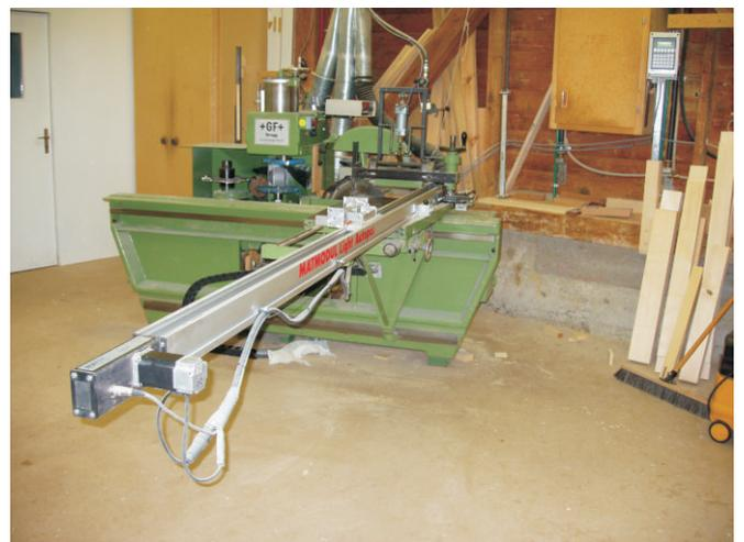
MATMODUL light Autopos automatisches Positioniersystem montiert auf Fenstermaschine
