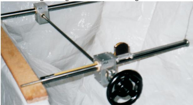
MATEC basic Parallelanschlag zum Aufbau auf Blechscheren, Abkantpressen, Furnierfügemaschinen, Papierschneidemaschinen, usw.
