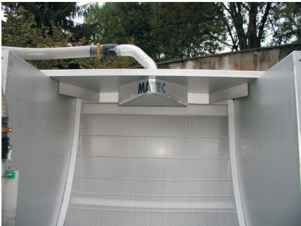
Die Flüssigkeit wird auf die ganze Siebbreite verteilt
