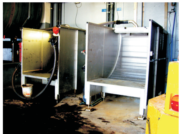
MATEC Nassabblader mit Anbautisch und Spritzwänden, Beleuchtung, Spaltsieb geschwungen, Fläche ca. 3 m 2
