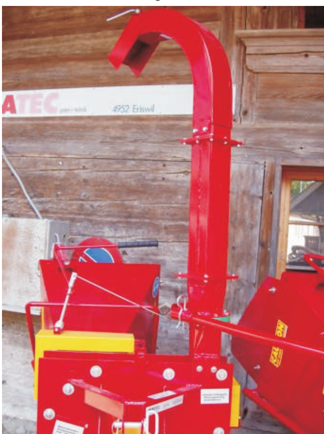
Preisgünstige Keilriemen als federndes Element zur Schonung von Getriebe und Hackscheibenlagerung. Rechts Getriebe für Einzugswalzenantrieb
