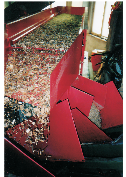
Vibrosieb MATEC Vibro Mesh standard 1 zur Trennung von Holzschnitzeln und Sägemehl
