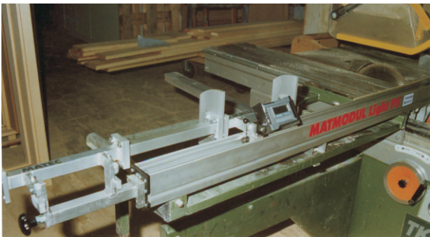
MATMODUL light teleskop monocar zum Aufbau auf Formatsägen, auf Wunsch mit Sinuskurvenscheibe mit autom. Längenausgleich beim Gehrungsschneiden
